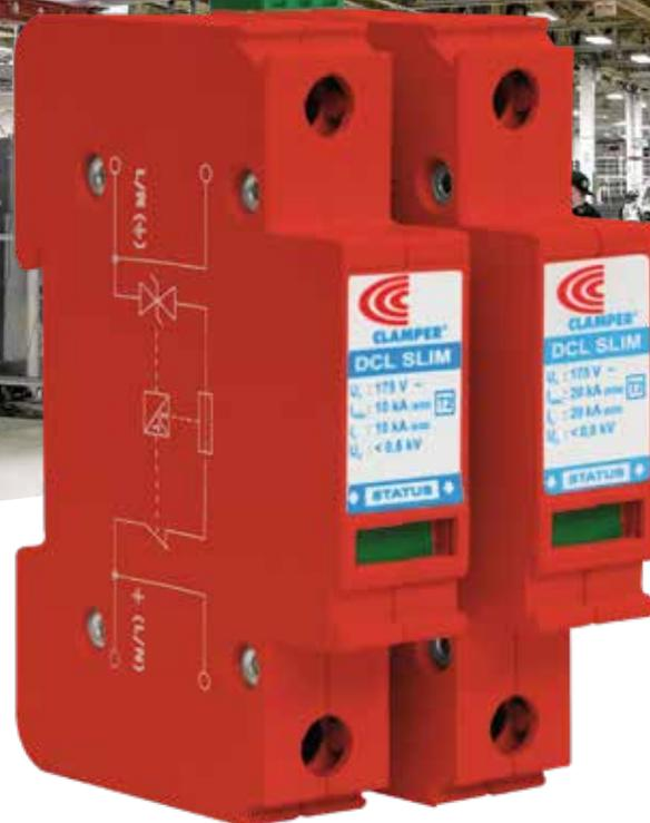
O DCL Slim é um dispositivo de proteção com a tecnologia SAD (Silicon Avalanche Diode), que apresenta menor tempo de resposta (da ordem de picosegundos) comparado com outras tecnologias de controle de sobretensões. Por se tratar de produto baseado em semicondutores, que não se degradam com o uso, o DCL Slim possui vida útil ilimitada para correntes de surto menores que a máxima suportável.
